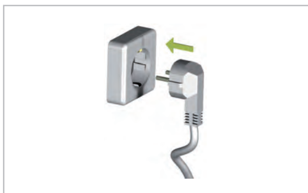
Fig. 5: Raccordement au réseau
